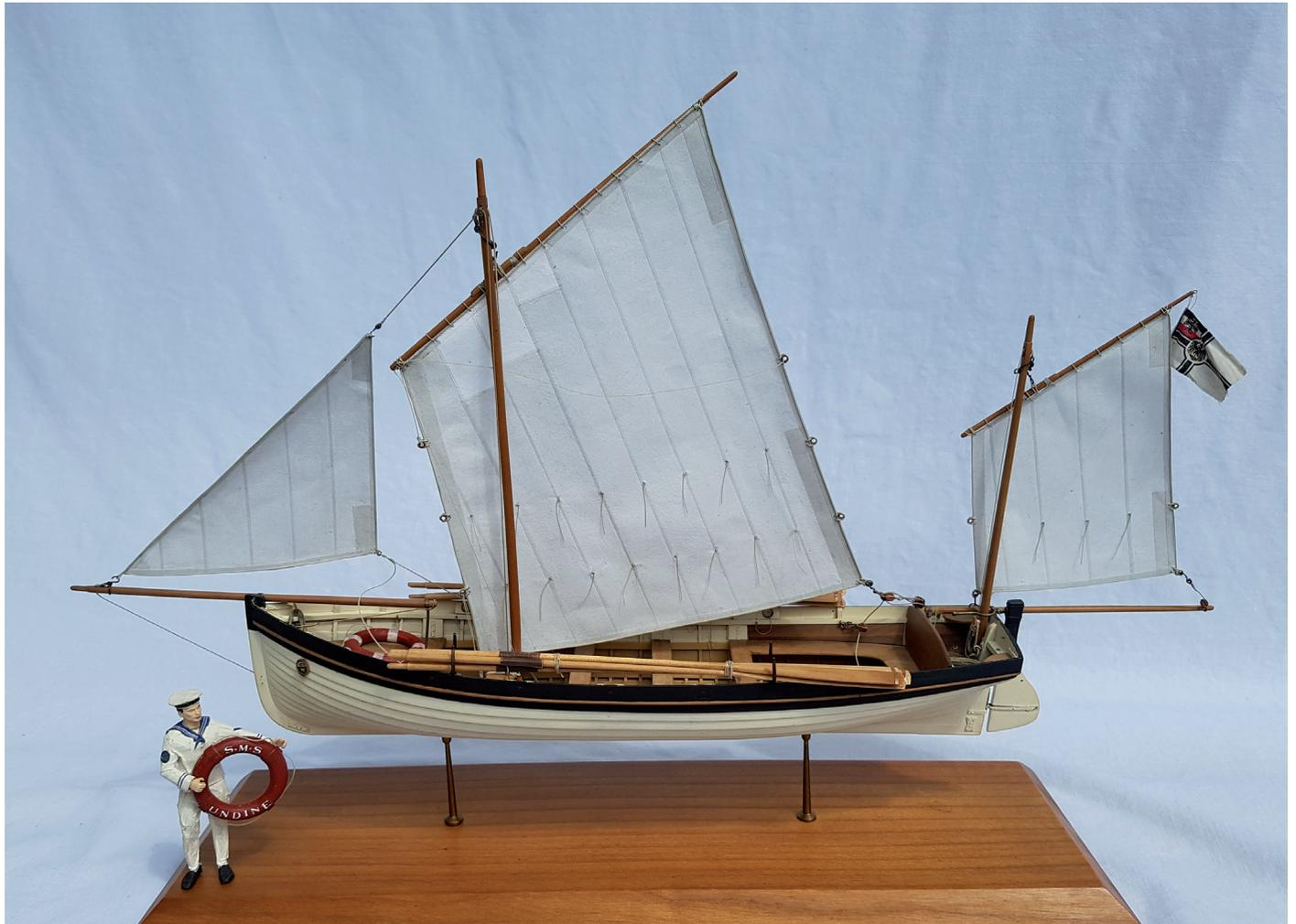
Abb. 1: Kutter Klasse IV voll getakelt und ausgerüstet. Modell im Maßstab 1:25, gebaut von Wolfgang Keckeisen. Foto © Wolfgang Keckeisen 2019.
